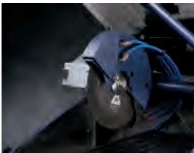
转轴式砂轮片保护罩设计更换砂轮片非常容易
