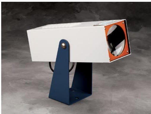
30-8050 PetroVue®薄切片观察器设计用于监测磨削过程中的切片厚度和均匀性。其提供偏振光源
