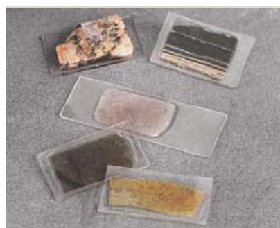
经切片和减薄至30微米的矿物样品
