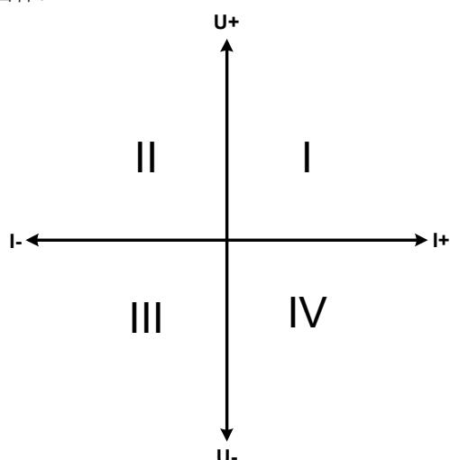
供电源与吸收源结合只能绘制I + II象限，顾名思义为“两象限操作”。供电源（电源）被定为“I”象限，而吸收源（电子负载）定为“II”象限。意指只能提供正向电压。
