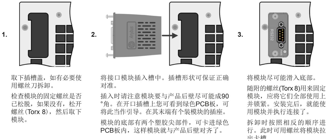
1. 取下插槽盖，如有必要使用螺丝刀拆卸。
