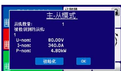
点击**初始化**会让主机再次搜索从机，然后设置所有必要参数来配置本机。如果发现一台或多台配置正确的从机，屏幕上就会显示从机数量，组合后的总电流与总功率。
