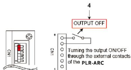
通过外部模拟控制接口关闭输出
