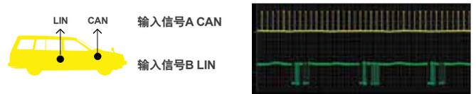
“A to B(n)”触发是指在输入B的指定边沿数量位置发生触发。该触发功能可用于时间偏移测试，例如非标准图像信号垂直/水平周期、电机参考位置脉冲和驱动脉冲。
