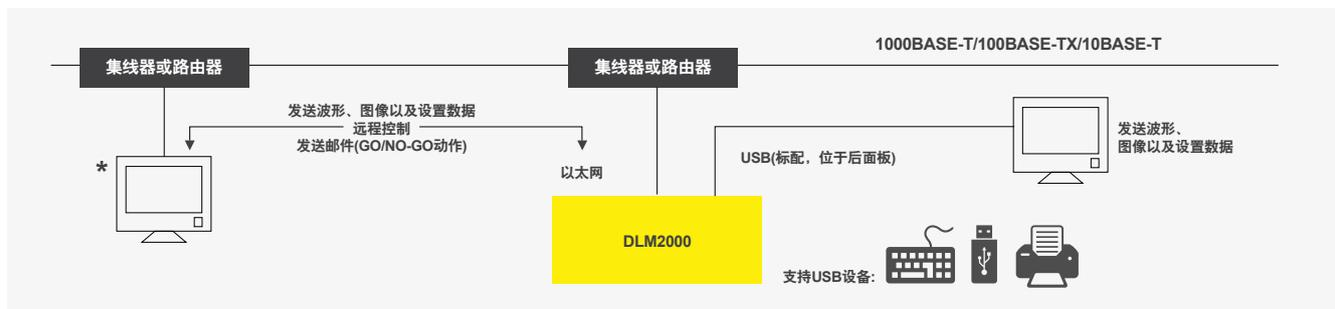
\* PC可以识别DLM2000内部HDD, 如同识别外部USB存储器一样。即使不使用USB驱动器, 也可以轻松传送文件。
