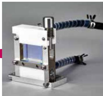
一体化流动样品池设计，拆卸与安装轻松完成。
