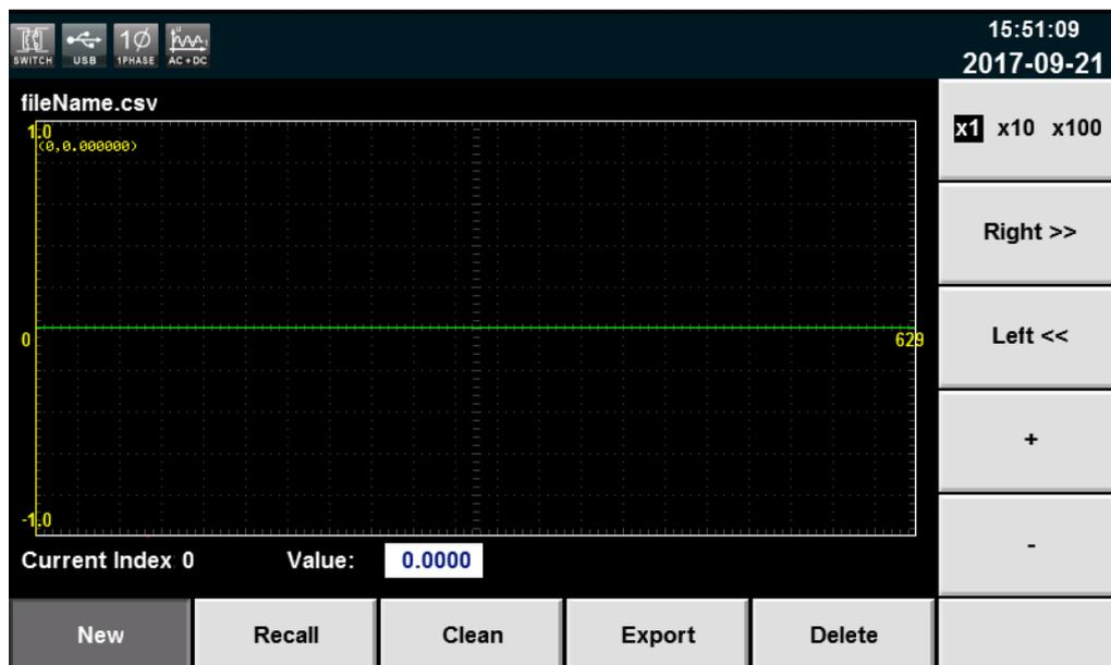
Recall: 调出已经存储的波形文件，导入 USB 存储设备中的波形文件。
