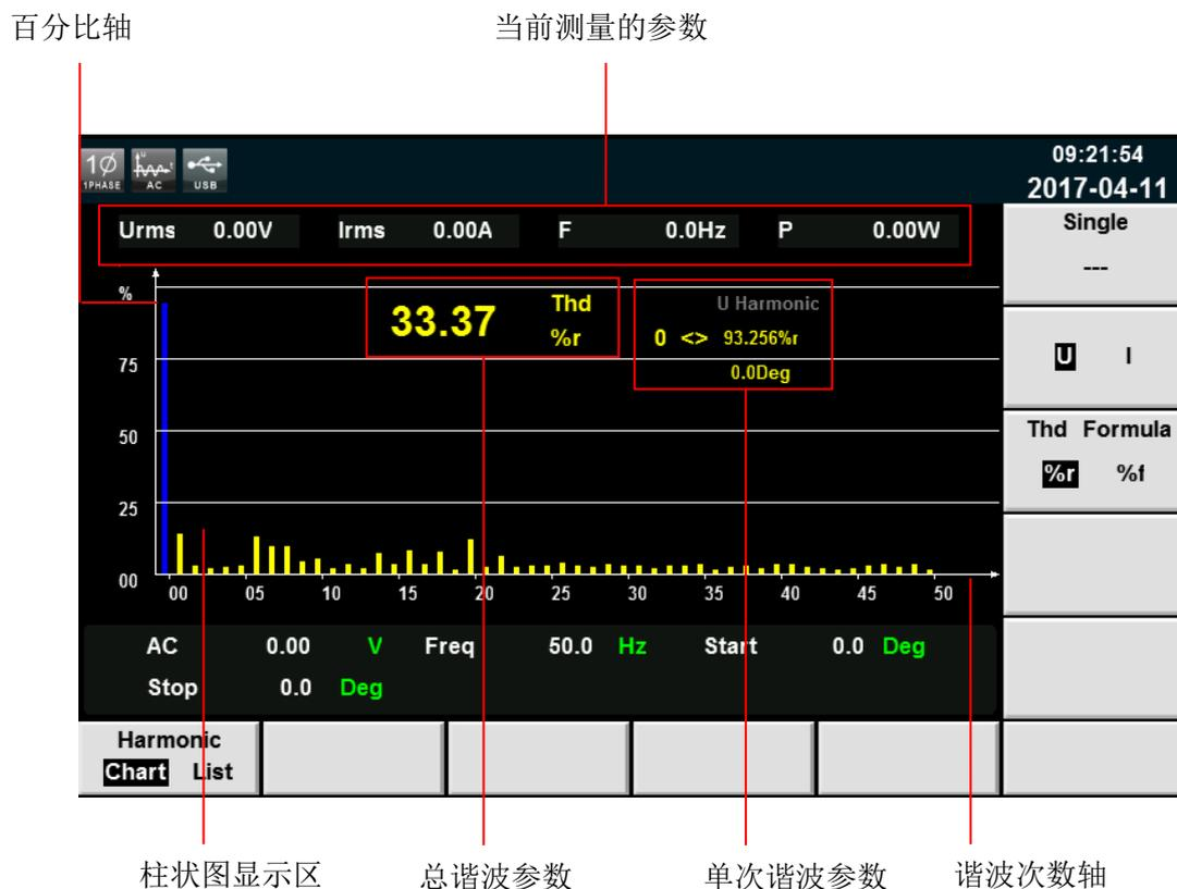
**总谐波参数:** 单相模式下，显示一相的总谐波失真率。三相模式下，显示 A、B、C 三个相位分别对应的总谐波失真因数(THD)。
