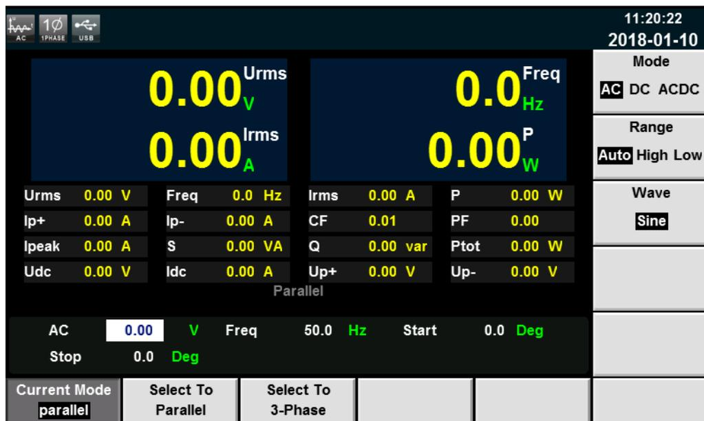
5. 按 Select To 3-Phase 对应的软键，按 **[Enter]** 进行确认。主机界面显示如下，从机界面相位（PHASE）分别显示为 B 和 C，代表三相并联成功。
