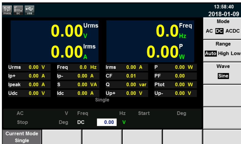
DC: 当直流电输出时的电压值，设置范围根据选择的量程而不同，详细范围参见技术规格书。
