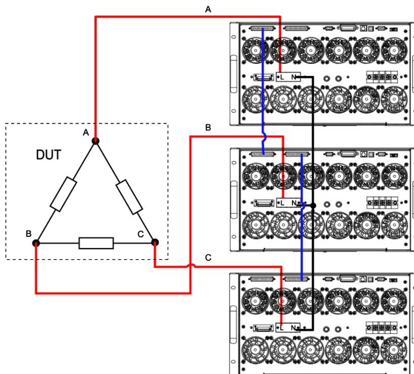
总线接口（SYSTEM BUS）需要用直连网线将 3 台设备相互连接，如上电源的三相连接图所示。选择上图中的一种接法，完成布线后，对机器内部关系进行配置。
