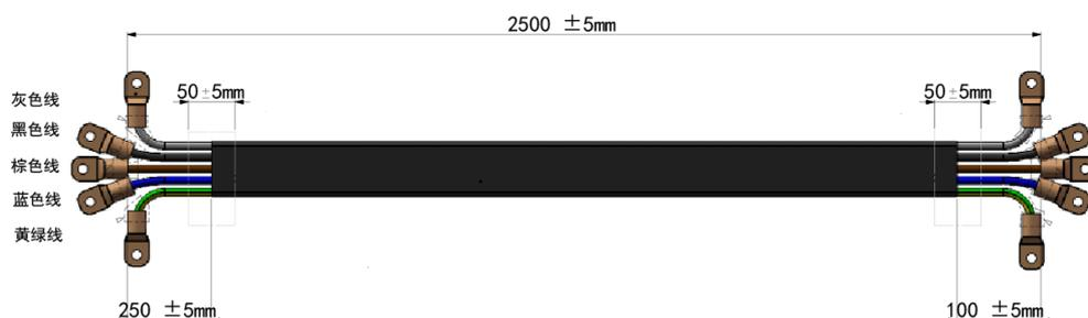
将电源线的五根线分别接入到交流配电箱上，棕色端子连接到 L1，灰色端子连接到 L2，黑色端子连接到 L3，蓝色端子连接到 N，黄绿色端子连接地线 PE。
