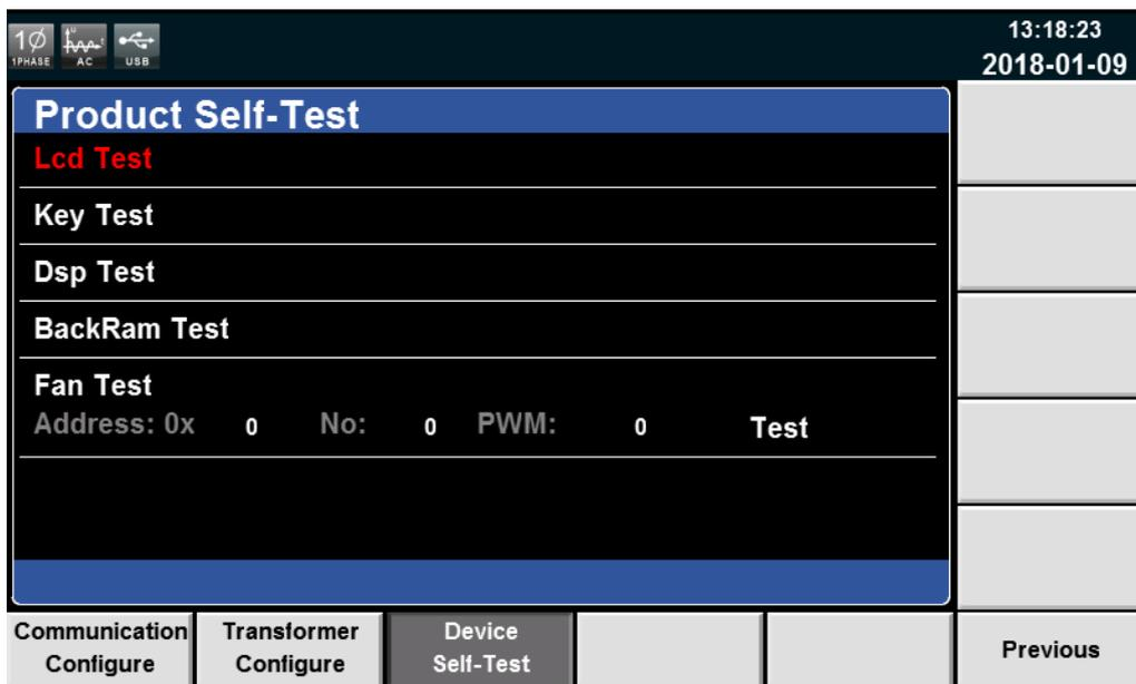
4. 按 **[Enter]** 按键，系统开始自检，显示 LCD Checking Finish 表示屏幕自检通过。
