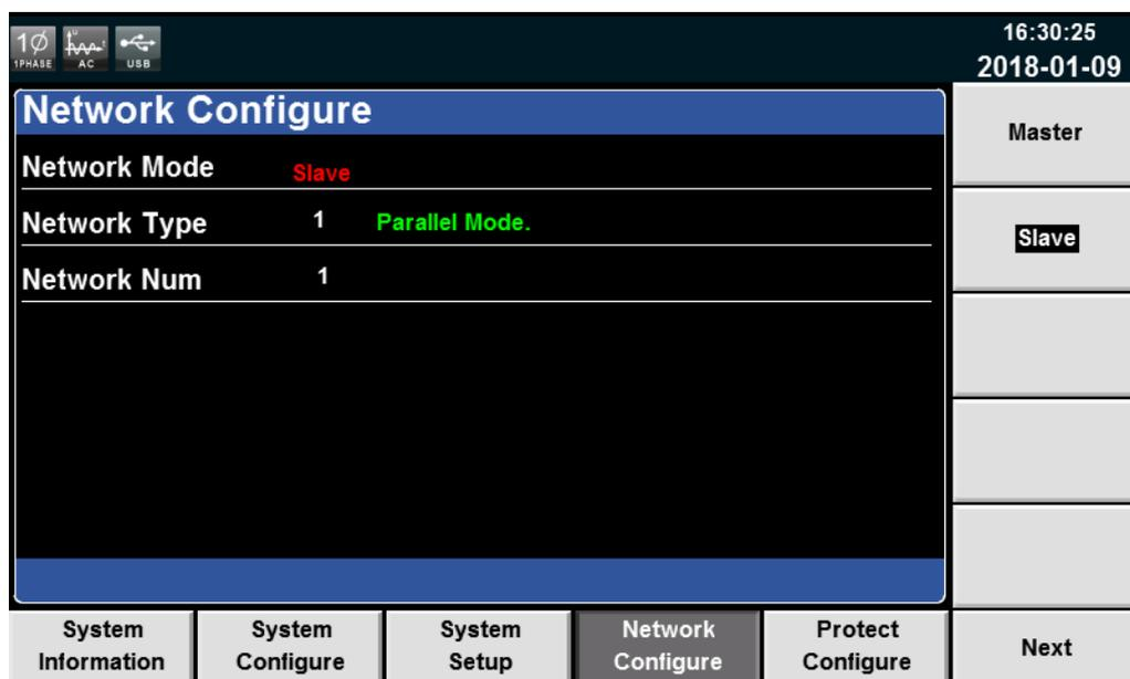
3. 按 **[Esc]** 返回主界面,按 **[Power]** 键关闭电源之后,重新启动机器(从机开机时间大约为 10s)。启动后,从机界面显示“SLAVE MODE!”,从机状态 (STATE) 为 INIT。
