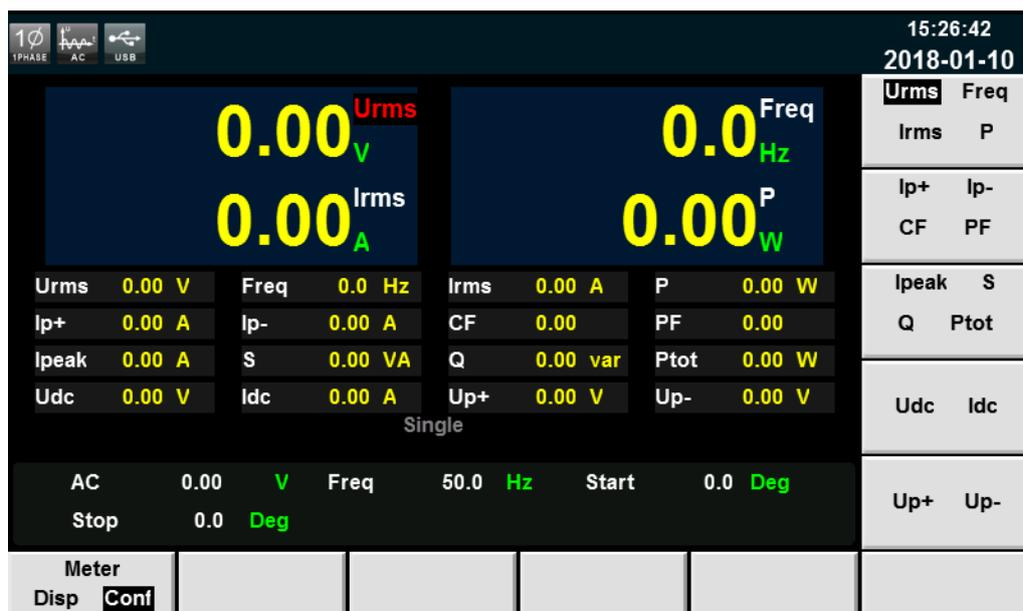
用户可以自定义屏幕参数显示类。界面上方显示 4 个大字体的参数值，如上图显示的是电压值、频率值、电流值和有功功率。按上下按键移动光标选中界面中显示的参数（字体背景为红色），并按右侧参数对应的软键调整当前显示的参数，依次进行设置。
