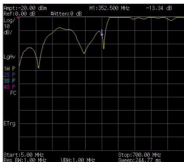
图 3-21 测量滤波器的回波损耗
