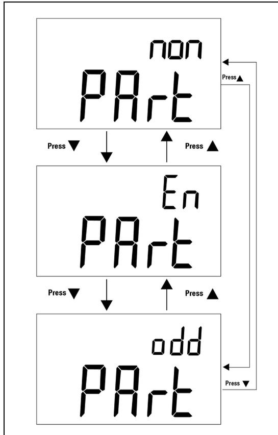
图 3-2 远程控制的奇偶校验设置
