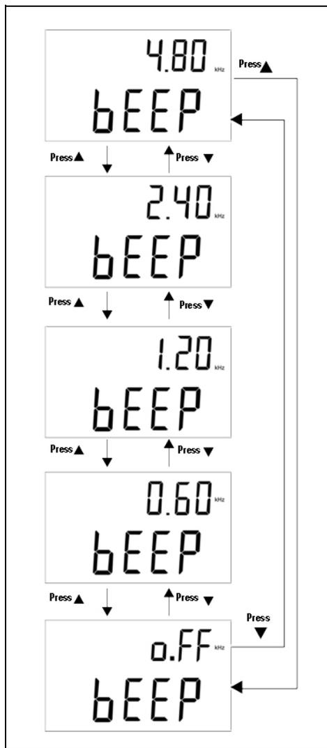
图 3-6 蜂鸣器的驱动频率设置
