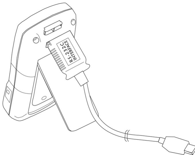
图 2-9 远程通信的电缆连接
