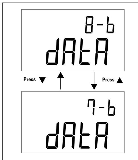
图 3-3 远程控制的数据位设置
