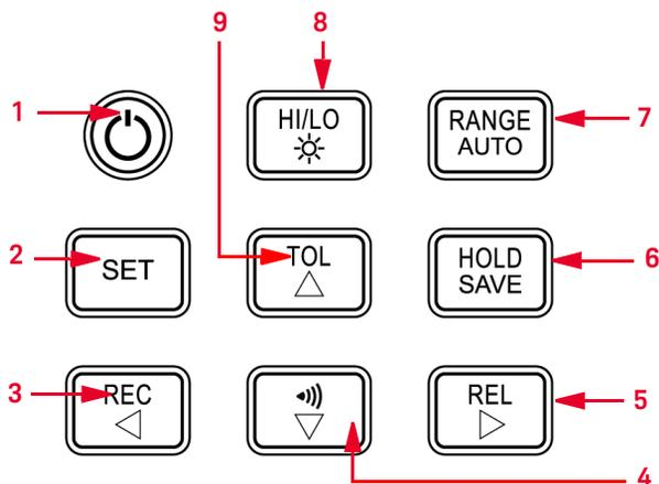
图 1-3 U1701B 双屏手持式电容测量仪的键盘
