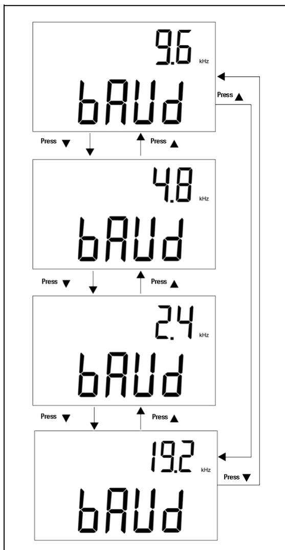
图 3-1 远程控制的波特率设置
