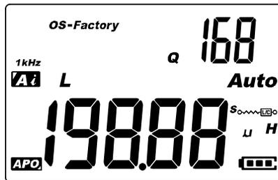
图 2-2 带有 Q 因子的电感测量
