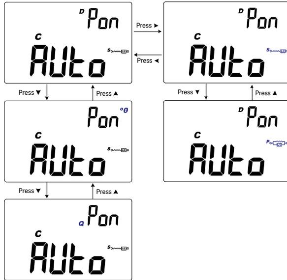
图 3-4 更改用于电容 (C) 测量的开机辅助参数和测量模式
