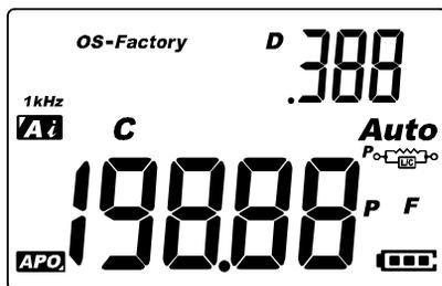
图 2-4 带有 D 因子的电容测量
