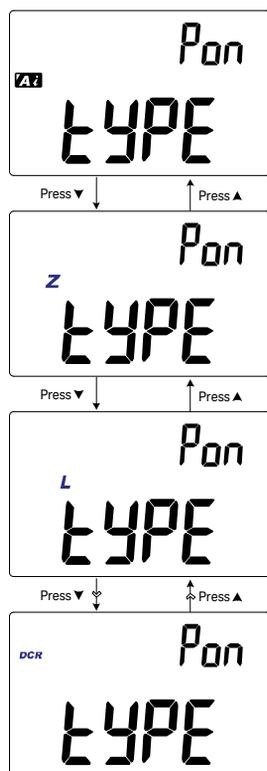
图 3-1 更改开机测量类型
