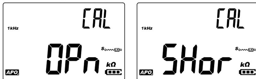
图 2-20 开路校准和短路校准提示
