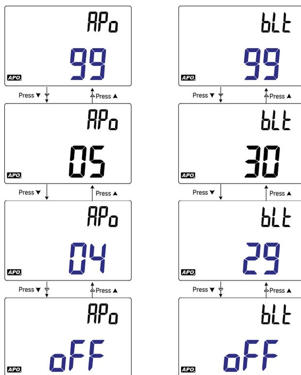
图 3-15 更改自动关闭电源和背光灯超时
