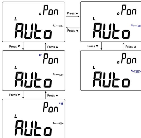
图 3-3 更改用于电感 (L) 测量的开机辅助参数和测量模式
