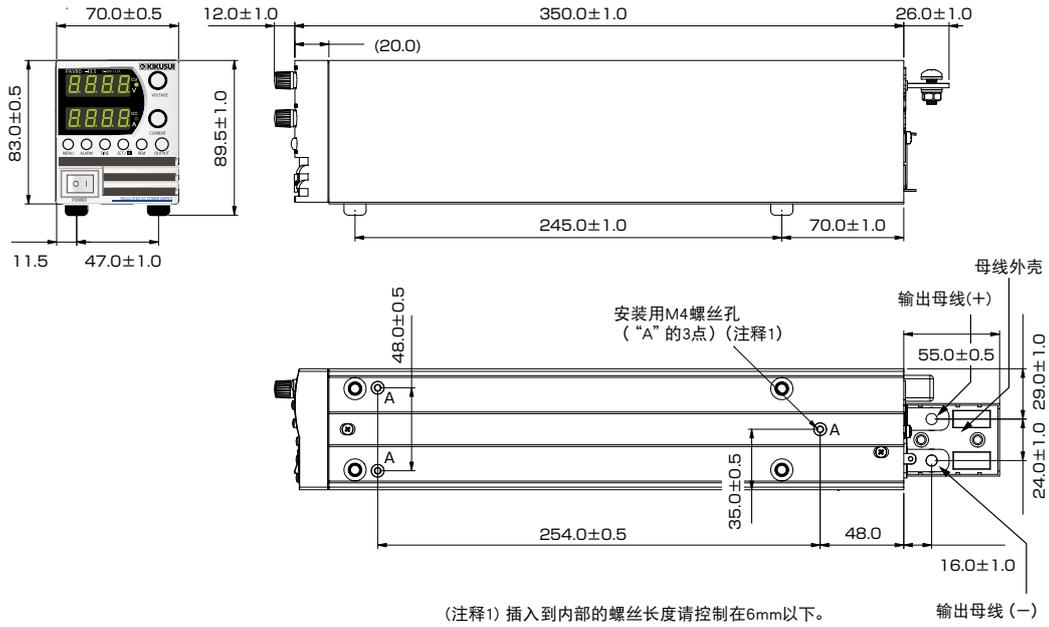
●Type II: 额定输出电压为160V-650V的机型
