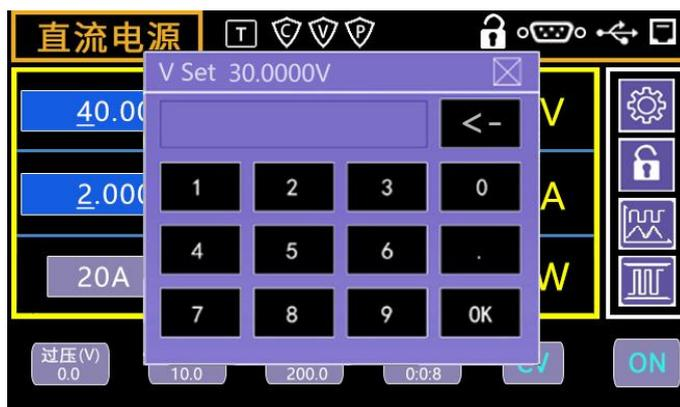
或者也可以按下电压旋钮移动光标，旋转电流旋钮设置具体数值即可，实际的电压、电流及功率会在屏幕上显示出来，以使用户能客观明了地读出电源相应的输出参数。
