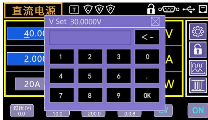
或者也可以按下电压旋钮移动光标，旋转电流旋钮设置具体数值即可，实际的电压、电流及功率会在屏幕上显示出来，以使用户能客观明了地读出电源相应的输出参数。
