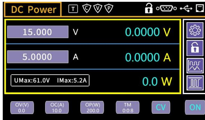
设置电压电流数值，具体方法：点击面板上需要设置的电压或电流数字会跳出如下图的键盘，点击数字键[0]~[9]，然后点击[OK]键确认，即可输入数值。
