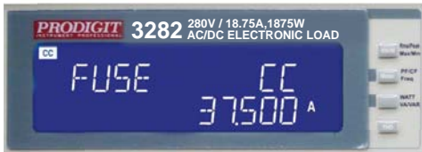
Turbo : OFF, Fuse mode 測試結果畫面
