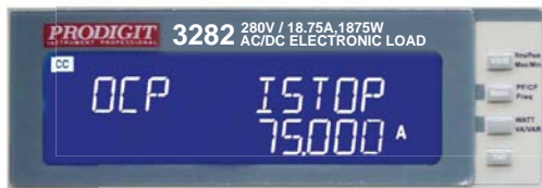
Turbo ON, OCF Istep 7.5 A Istop 75A 測試結果畫面
