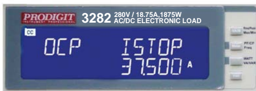
Turbo OFF, OCF Istep 3.75 A Istop 37.5A 測試結果畫面
