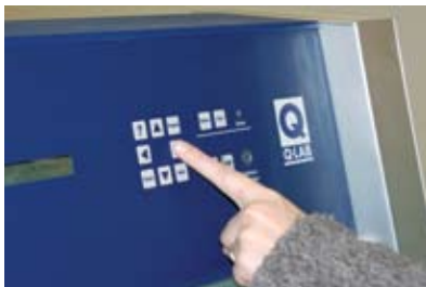
操作者选择所需的辐照度，选定的辐照度即为“设定点”。
