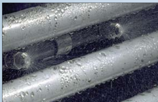
QUV/spray 模拟热冲击和应力腐蚀对材料的破坏。
