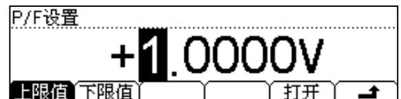
Pass/Fail 运算功能可根据设定的上下限参数，对超出范围的信号进行提示，使测试结果一目了然。
