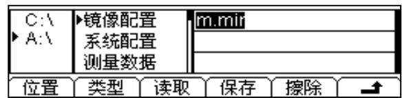
您可以通过 U 盘将所有配置(系统配置和传感器配置)“克隆”到产线上的其他 DM3058/DM3058E 万用表中，从而提高产线工作效率。
