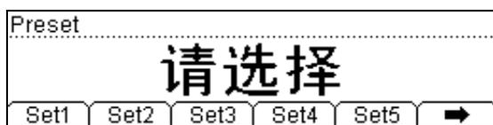
提供预设的工作模式。该模式可最大程度简化产线工人的操作。用户可快速存储和调用 10 组预存配置。
