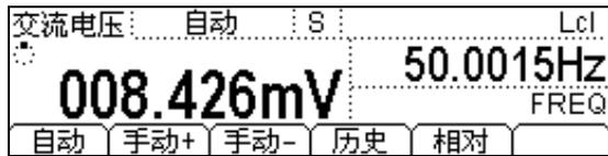
灵活方便的双显功能可使您的测量工作达到事半功倍的效果。双显示屏可同时显示同一信号的两种特性，而在以往则需要使用两台万用表或连续进行两次测量。利用双显示屏，还可显示被测输入信号的测量组合。
