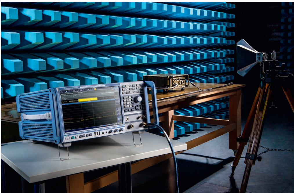
在电波暗室中进行 EMI 测试。
