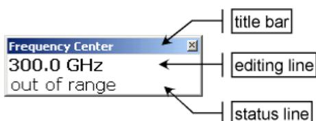
图 5-2: 用于参数输入的编辑对话框
