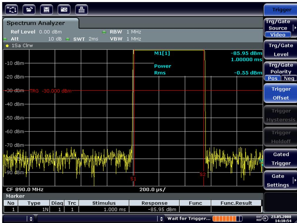
图 6-11: 突发信号激活阶段的功率测量
