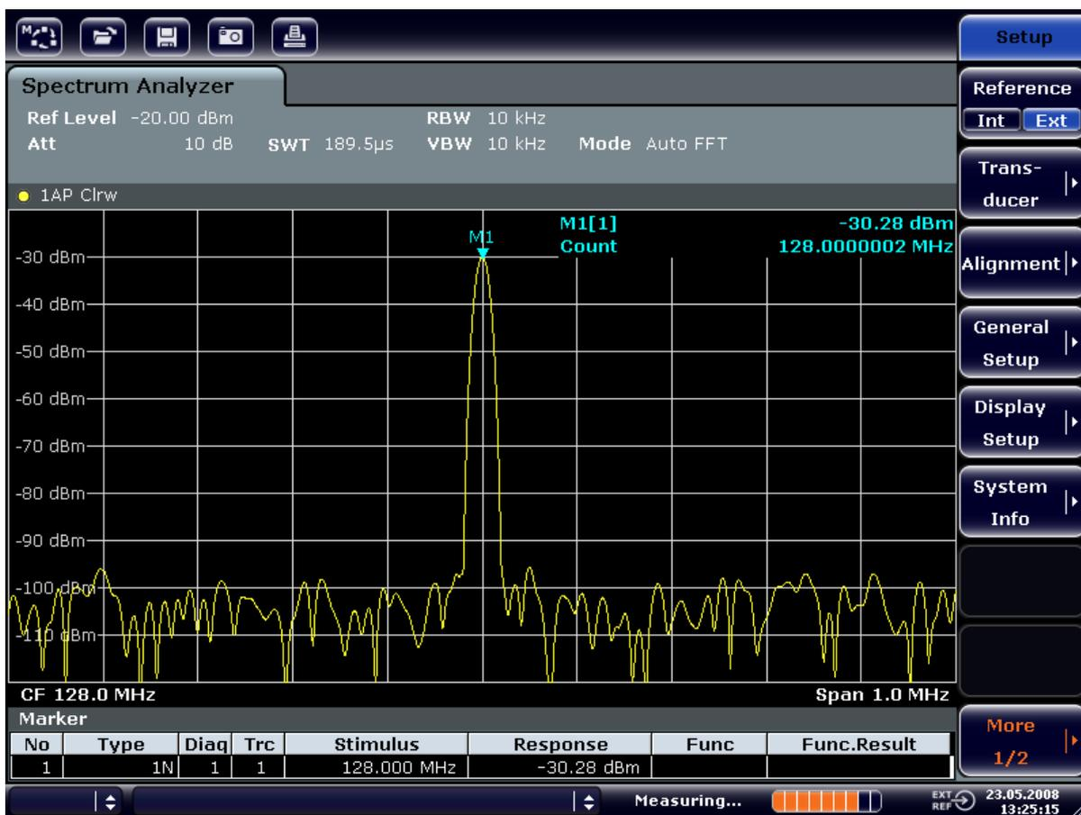
图 6-1: 使用频率计数器测量频率
