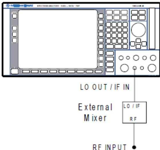
1. 将 R&S FSVA/FSV 的 LO OUT / IF IN 输出连接至外部混频器的 LO/IF 端口。标称 LO 电平为 15.5 dBm。
