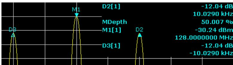
图 6-7: 测量调幅调制深度。
