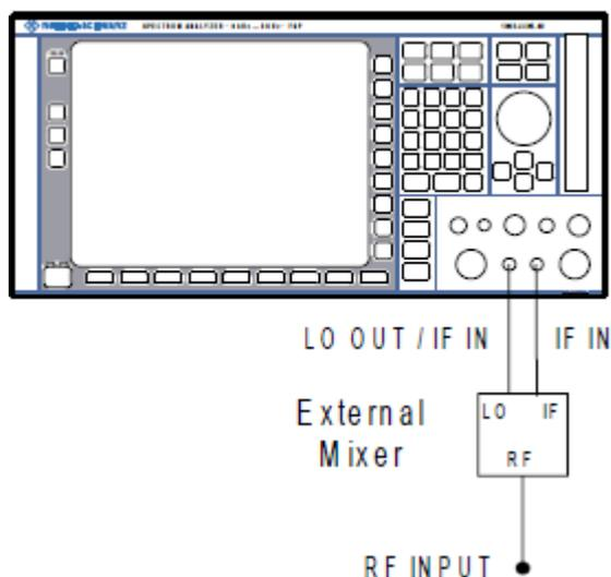
1. 将 R&S FSVA/FSV 的 LO OUT / IF IN 输出连接至外部混频器的 LO 端口。
