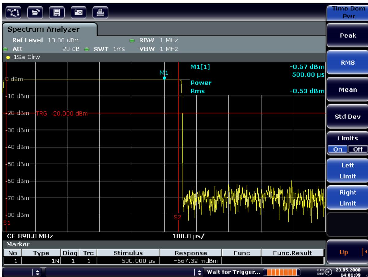
图 6-8: 测量 GSM 信号突发期间的平均功率
