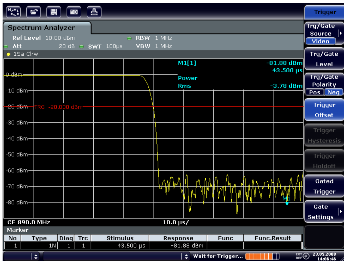
图 6-10: 高时间分辨率下显示的 GSM 突发信号的下降沿
