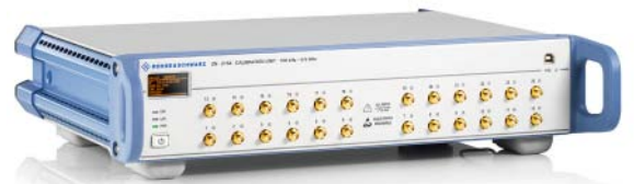
R&S®ZN-Z154 24端口校准单元。
