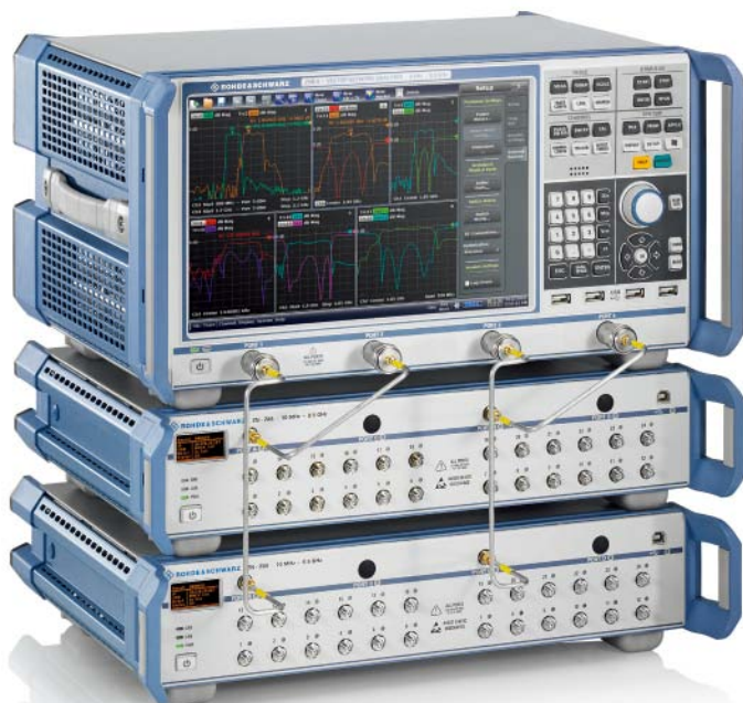
带两个R&S®ZN-Z84开关矩阵的R&S®ZNB。
