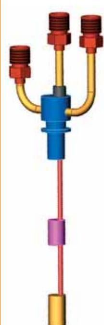
材料及化学反应的研究通常与汽化倒置升呀有关，其中压力是一关键参数，需加以研究及控制。两种形态的密闭型坩埚供选择，**给予坩埚内增压而量热传感器常压模式下工作**，这是必要的为的是保证SENSYS的测量精确度。
