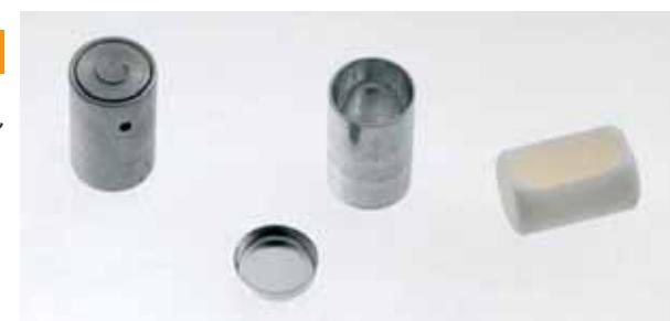
坩锅的容量非常适合不同类型的**复合材料分析**，或**低能材料相变**。特别在样品产生的压力比较低时适用。
