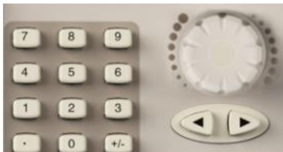
图1-19 数字按键、旋钮和方向键
