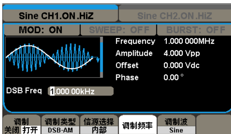
图3-9 输出DSB-AM 调制波
