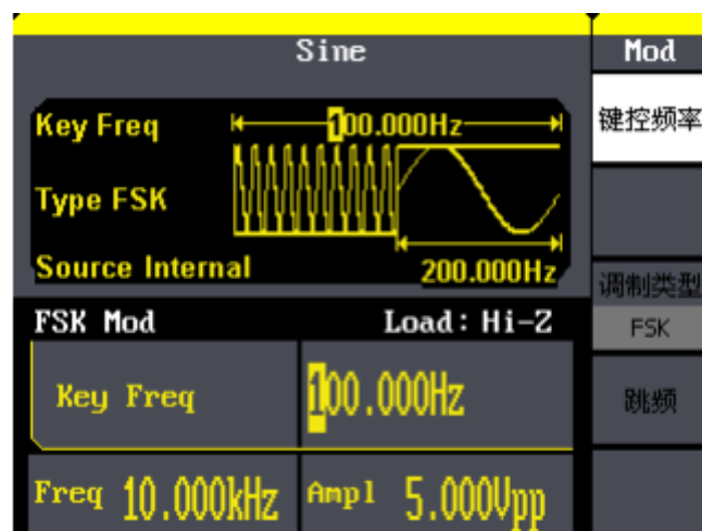
图 3-13 输出 FSK 调制波形
