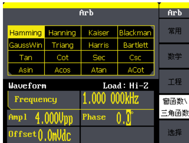
图 2-19 窗函数\三角函数内建波形显示界面
