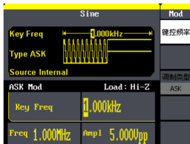
图 3-14 输出 ASK 调制波形
