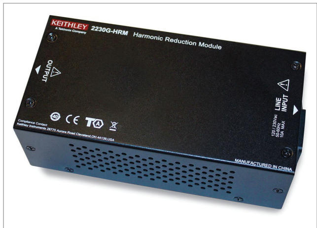
2230G-HRM 谐波缩减模块插入电源和与电源插座之间，减少了 AC 电源线电流谐波。为满足欧盟 EN 61000-3-2 标准，要求使用 2230G-HRM，适用于 2230G-30-6 和 2230G-60-3。
