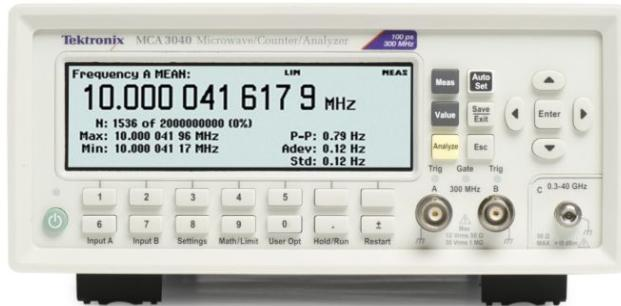
MCA 系列拥有业内领先的频率和时间分辨率，标配内部存储器、向存储器传输的快速数据传输速率为 250k 个样点/秒以及集成功率计。多参数显示器在主测量值的旁边显示辅助测量值，让您可以一览所需的结果。提供业内最全面的分析模式，包括测量统计、直方图和趋势图，让您拥有快速准确分析信号所需的工具。
