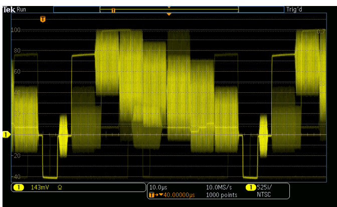
查看 NTSC 视频信号，注意 MDO3000 提供的辉度等级视图，其能够表示时间、幅度和幅度分布随时间变化。
