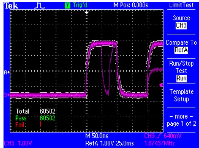
极限测试可以将任何触发的输入信号与用户定义模板进行比较，快速提供通过/失败结果。
