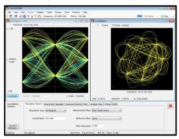
Option VM07 PDC, ( $\pi$ /4 DQPSK, 21 kS/s, 800 MHz, 0 dBm), RMS EVM: 0.6%
