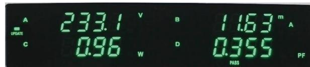
由图可见,该变压器初级空载参数为空载电压:233.1V,空载电流 11.63mA,空载功率 0.96W, 功率因数 0.355
